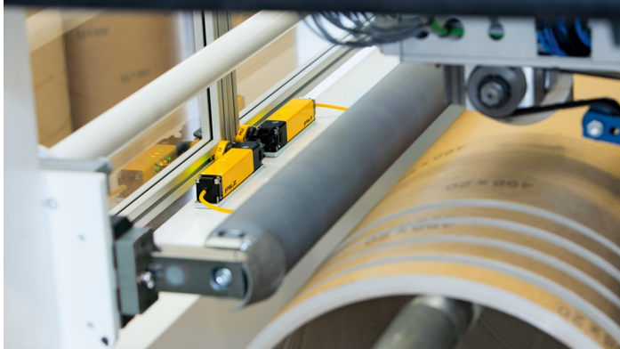
标题: ISO 14119规定了带联锁开关的安全门的设计原则。现在有一个新版本的标准。(图片: © Pilz GmbH & Co. KG)
