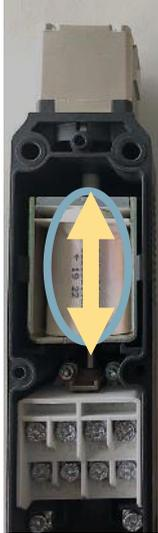
Abbildung 9 Innenansicht elektromechanische Zuhaltung PSEN me5
