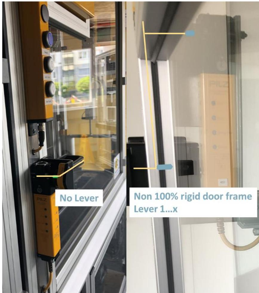
Abbildung 8 Hebelwirkung auf einer Zuhaltung an Türen
